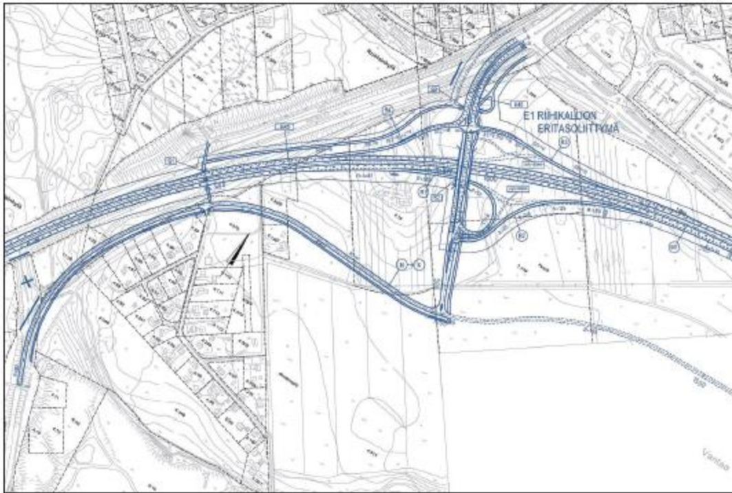
Kuva 34. Riihikallion eritasoliittymä, vaihtoehto B, tarkennettu suunnitelma.
